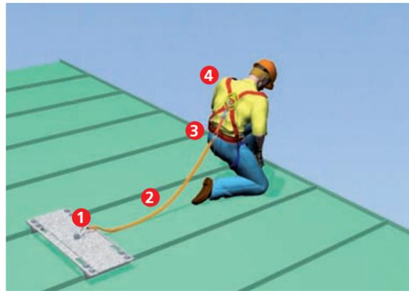
Auffangsystem mit Falldämpfer
