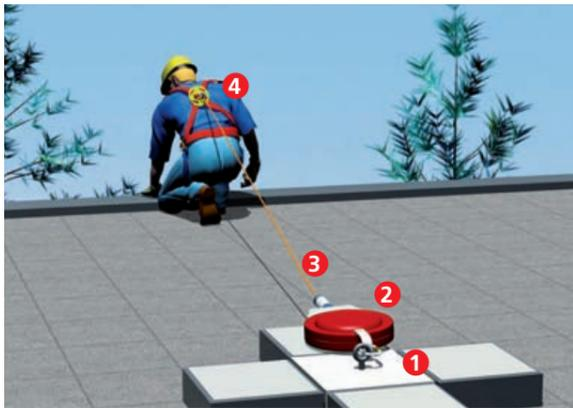
Auffangsystem mit Höhensicherungsgerät
