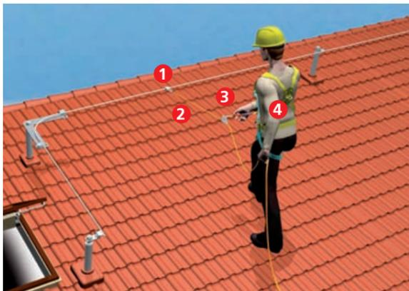
Auffangsystem mit mitlaufendem Auffanggerät einschließlich beweglicher Führung und horizontaler Anschlagvorrichtung
