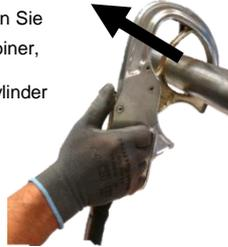
**3** Stecken Sie das Spezialwerkzeug (Art.-Nr. DAS 226) links des Kabels unter den Schließzylinder und drücken Sie auf den Riegel.
