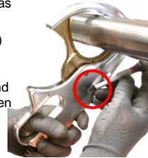
**4** Entfernen Sie das Spezialwerkzeug (Art.-Nr. DAS 226) und drücken Sie dabei weiterhin in Öffnungsrichtung auf den Schließzylinder.
