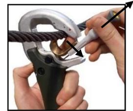
**4** Entfernen Sie das Werkzeug (Art.-Nr. DAS 226) und drücken Sie dabei weiterhin in Öffnungsrichtung auf den Schließzylinder.
