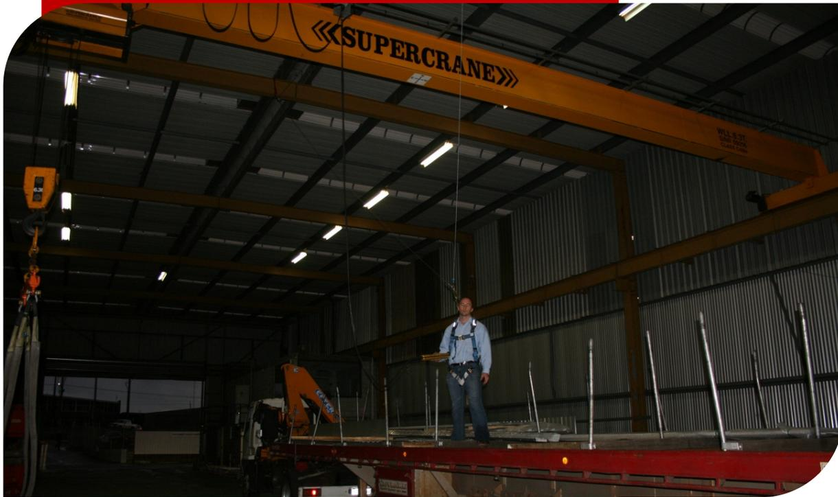
Beim Beladen von Tieflastern kann die Beurteilung des Absturzrisikos problematisch sein, da herkömmliche Schutzvorrichtungen nicht ausreichen, um einen Aufprall am Boden zu verhindern.
